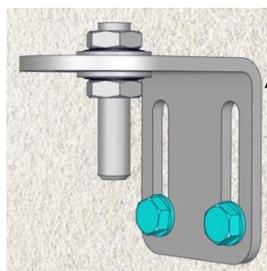
9- remettre en place les vantaux sur les gonds bas après avoir graissé l'axe., descendre les gonds dans les montants. Vérifier les aplombs et serrer définitivement.
